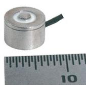
自社製ひずみゲージによる、4ゲージ方式を採用し、小型、高精度、低価格を実現しました。ご使用中のエジェクターピンの底部に設置する方式のため、エジェクターピン径の制約を受けない自由な金型設計が可能です。
