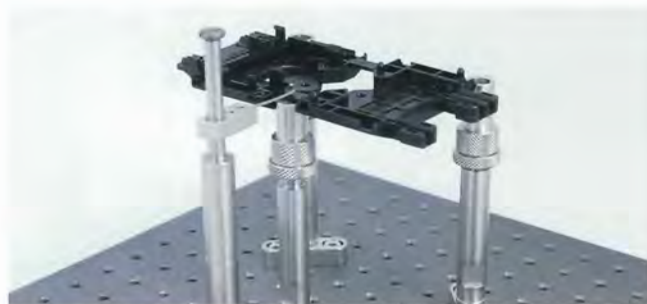
グリッドプレートにCARFIT CMK固定具で測定ワークを固定した例
