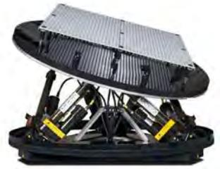
アンテナ・センサー 6 軸振動評価試験装置
