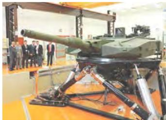
角度制御機器 評価・検証試験装置
