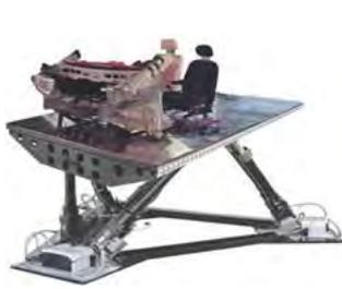
電動式シート乗り心地評価試験装置
