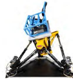
電動式 燃料タンク、燃料輸送機器 評価試験装置
