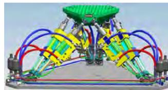
油圧式 小型 6 軸試験装置
