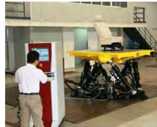
油圧式 6 軸多用途 高周波振動試験装置
