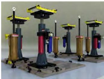
油圧式 4 軸 (8 軸) 耐久・NVH 試験装置
